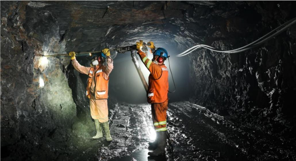
*Airleg team drilling blastholes in 992W*
